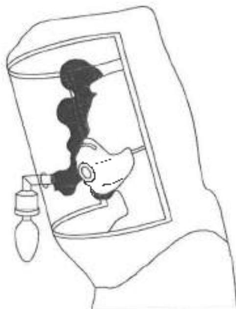
figura A.2 Prova di tenuta mediante sostanza amara o dolce
